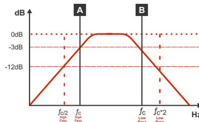
Establezca en el control variable "SUBSONIC" entre 5Hz y 40Hz ("A") donde desea realizar el filtro de corte subsónico;
